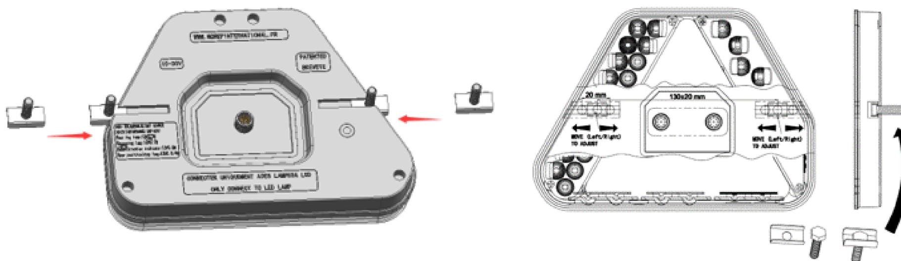
Les feux LED Norep sont **étanches IP69K** et fabriqués en polycarbonate résistant aux chocs. Les montages sont prévus avec des vis ou rivets et sont ajustables en position grâce à un système de rainure en T.
