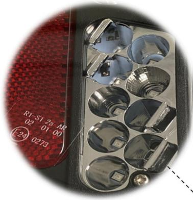
Signalisation optimale et durée de vie plus longue grâce aux Led.
