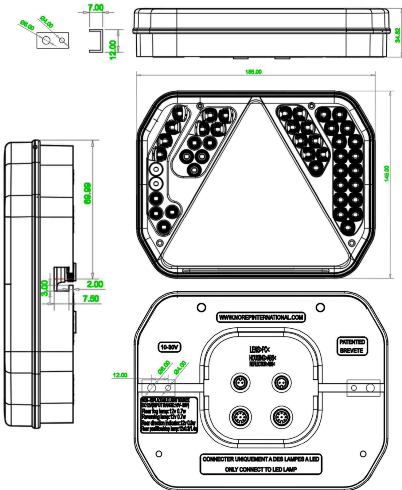
Les feux LED Norep sont **étanches IP69K** et fabriqués en polycarbonate résistant aux chocs. Les montages sont prévus avec des vis ou rivets et sont ajustables en position grâce à un système de rainure en T.
