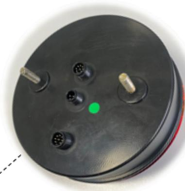
Montage à vis et écrou, entraxe 80mm.
